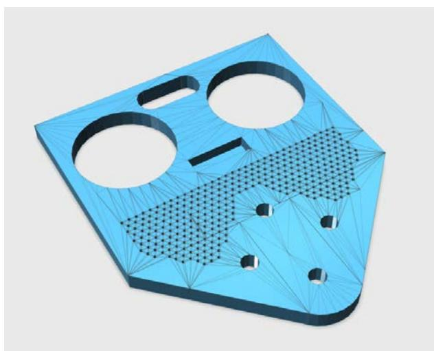
Рис. 3. 3D-модель крепления бокового дальномера.
