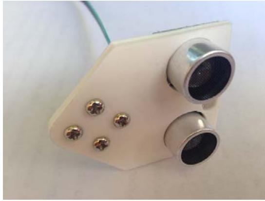
Рис. 7. Готовое крепление с установленным дальномером.
